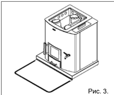
**Рис. 3.** При установке каменки на пол из горючих материалов следует использовать монтажную подставку. Перед монтажной подставкой укладывается металлический лист, края которого должны выступать за периметр дверцы топки на 100 мм в боковом направлении и на 400 мм – во фронтальном направлении. Кромку металлического листа, обращенную к каменке, необходимо загнуть, прижав ее к печи с тем, чтобы искры из топки не попадали под монтажную подставку.
