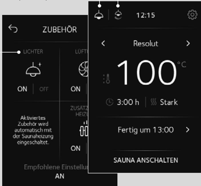
1. Die Lichter können durch Betätigen des Symbols ein- und ausgeschaltet werden.
