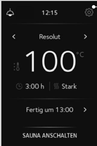
In die Einstellungen des Bedienpaneels gelangt man durch Betätigung des Symbols in der rechten oberen Ecke der Anzeige (1).
