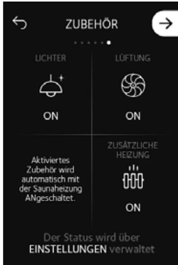
Dies ist eine Voransicht des physisch installierten Zubehörs, die mit dem Bedienpaneel verbunden sind. Alles angeschlossene Zubehör ist automatisch aktiviert, und Sie können es über die Einstellungen des Paneels regeln oder überwachen. Betätigen Sie die Taste WEITER und machen Sie weiter, bis zum Ende des Bedienungshandbuchs.
